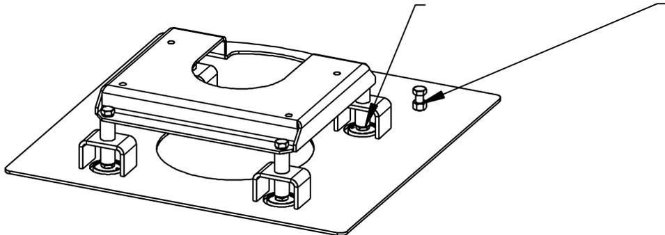
2) Auf die Blechbasis kleben Sie die Dichtung 6 x 33 im Umfang des Bleches 2x auf und setzen Sie den keramischen Sockel ein
