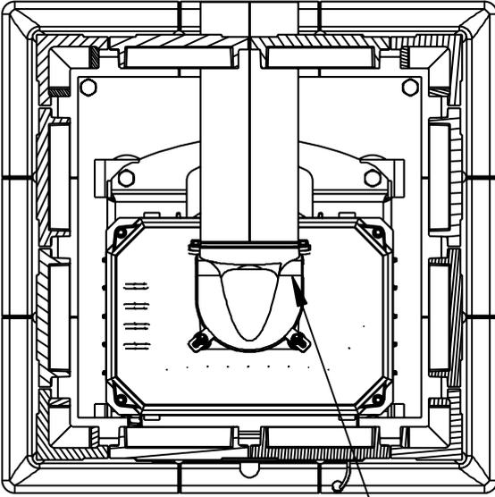
Um die Abgasführung nach oben umzudrehen, drehen Sie diesen Teil – demontieren Sie 4 Stücke der Schraubenmuttern, nehmen Sie die Füße ab, drehen Sie den Teil und montieren die Schraubenmuttern wieder an
