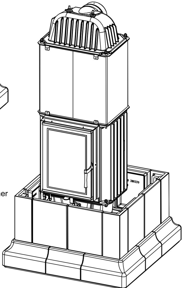
5) Auf den Kamineinsatz montieren Sie den Wärmetauscher an und in diesen Wärmetauscher installieren Sie Speichersteine nach dem beigefügten Plan, auf den Wärmetauscher montieren Sie die Gusskuppel an
