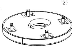
3) Montieren Sie das Blech der Basis zurück 4x Schraube M 16 x 30
