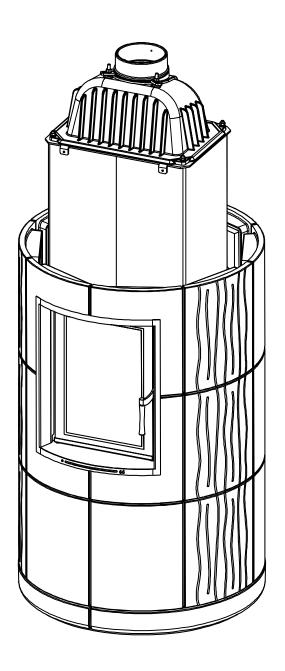
9) Wenn der Kamineinsatz einen kurzen Luftbetätigungshebel hat, tauschen Sie ihn gegen einen längeren aus, setzen Sie den Blendrahmen auf – sichern Sie ihn mit 4 Schrauben
