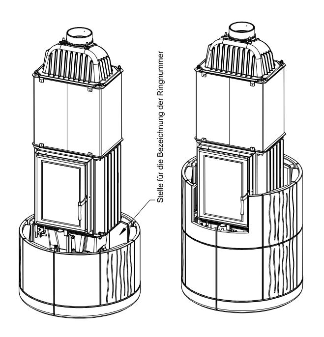
7) Setzen Sie den zweiten Kachelring – Nr. 2 auf Für bessere Akkumulation kleben Sie Akkuscheiben in die Kacheln ein
