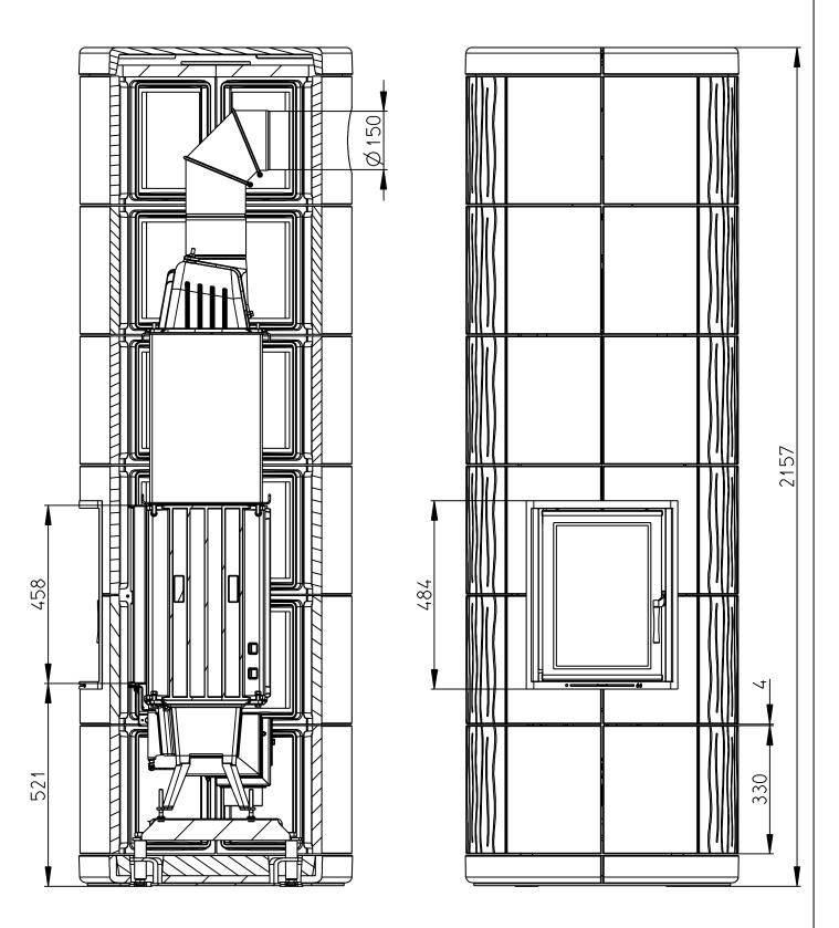
Kote 521 mm – Prüfmaß der unteren Kante des Türrahmens Kote 458 mm – Gesamtmaß der Türrahmenhöhe
