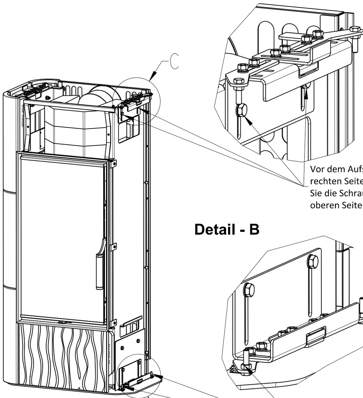
Vor dem Aufsetzen des rechten Seitenteils lockern Sie die Schrauben des oberen Seitenteilhalters.
