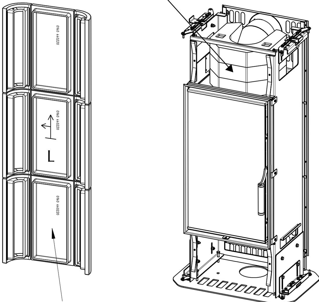
Linkes Seitenteil "L" – die Pfeile zeigen die Richtung der Platzierung von dem Seitenteil an den Korpus (nach oben zur Deckplatte und nach vorne zur Türe).
