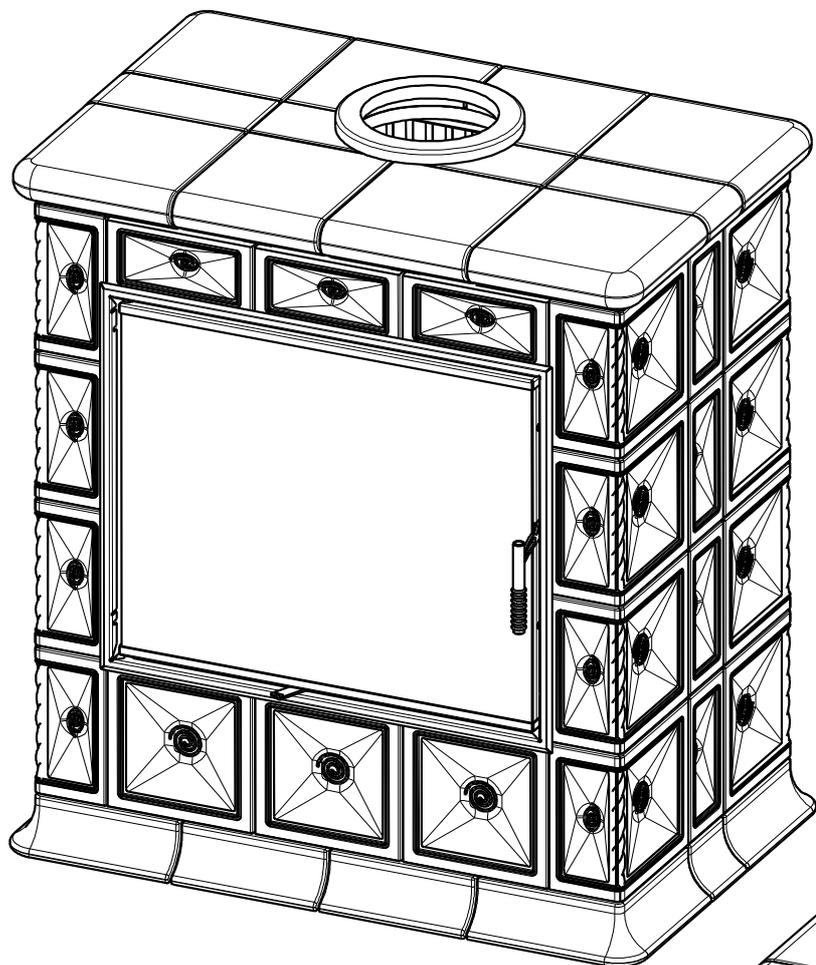
12) Setzen Sie den oberen keramischen Deckel auf und füllen Sie alle Stöße mit dem Silikon - Dichtmittel aus. Saubern Sie die Stöße mit Geschirrspülmittel Emulsion.
